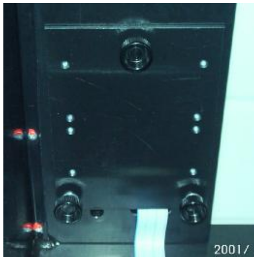
Rändelschrauben für das Display (hinten)
