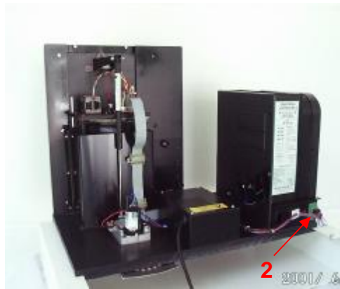
Rückansicht Inline mit Verbindungsstecker (2) für Hopper
