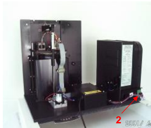
Rückansicht Inline mit Verbindungsstecker (2) für Hopper
